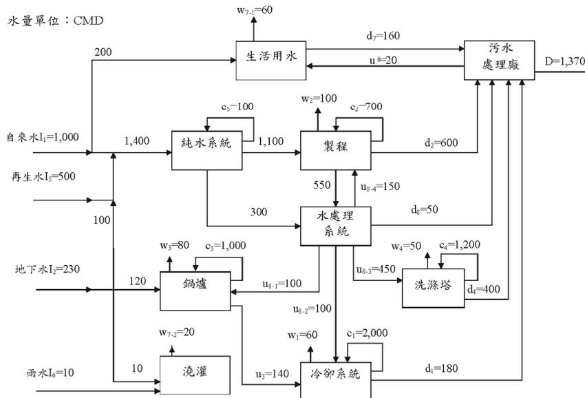
圖 4.5 一般工廠用水平衡圖繪製範例
