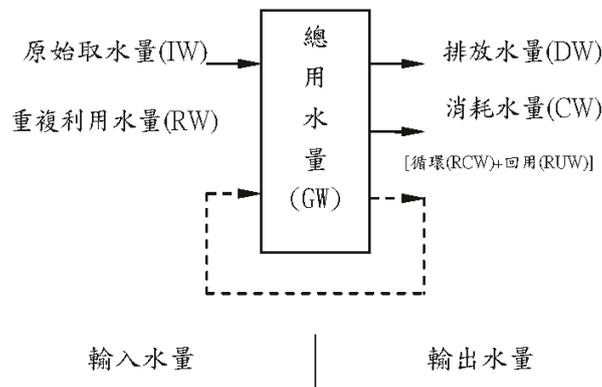
圖 4.3 水平衡系統分析示意圖 上述水平衡系統分析
